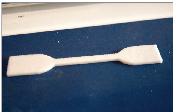
Fig. 1. Prototype of a sample prepared in the 3-D printing technology. Prototyp próbki testowej wykonany w technologii drukowania przestrzennego.
