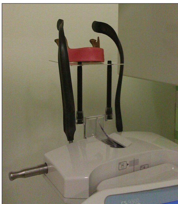
Fig. 2. A volumetric CS 9300 cone beam scanner with the study model. Aparat wolumetryczny CS 9300 z modelem badawczym.
