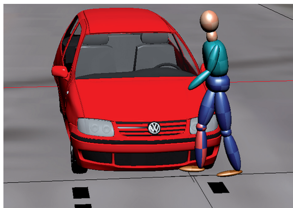
Ryc. 2. Przykład biomechanicznej symulacji potrącenia pieszego
