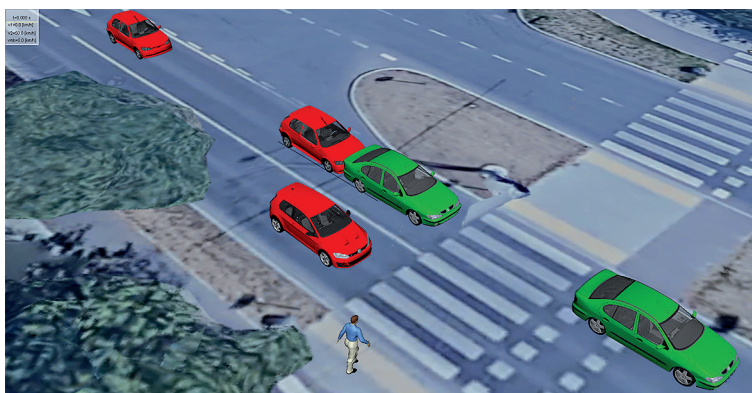
Ryc. 15. Przebieg przykładowej kolizji przy nieadekwatnych parametrach EES deformacji obu pojazdów Fig. 15. Collision sequence with inadequate EES deformation parameters for both vehicles
