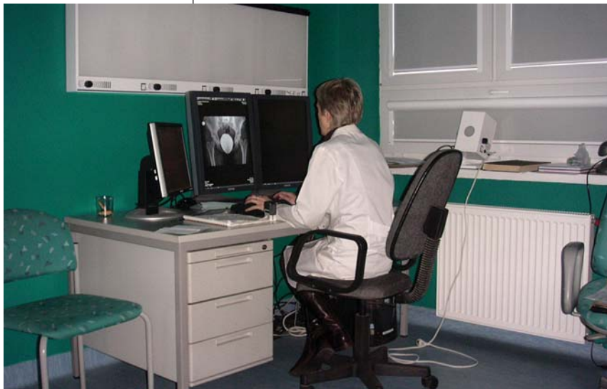
Ryc. 4. Opisowa stacja diagnostyczna z dwoma monitorami 2-megapikselowymi i jednym monitorem do RIS. Wszystkie monitory mają ustawione czarne tło, pokój opisowy jest zaciemniony, ściany pomalowane są na ciemny, matowy kolor. Z badań wynika, że nadmiar światła oraz światło odbite od powierzchni monitora w dużym stopniu zaburzają ocenę obrazów, a także powodują zmniejszenie kontrastu (1., 2.)
